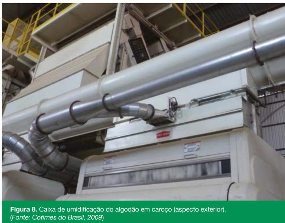
**Figura 8.** Caixa de umidificação do algodão em caroço (aspecto exterior).
